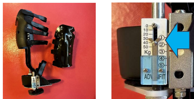
図2) 指示針が停止した位置で荷重量を確認できる。
