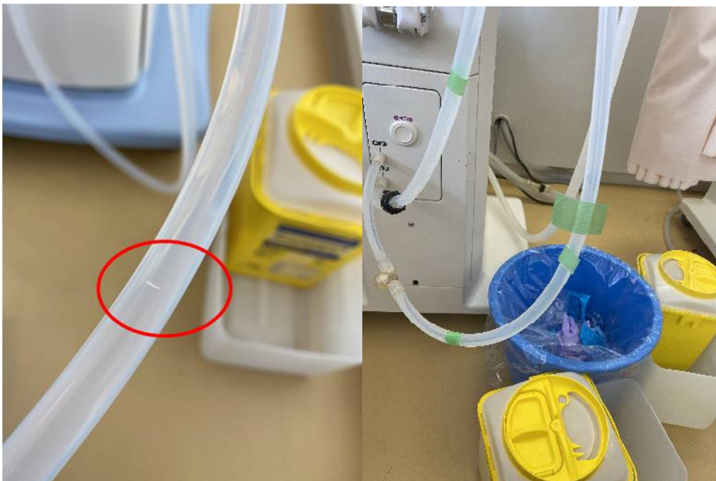
図1 発見したシリコンホースの損傷
